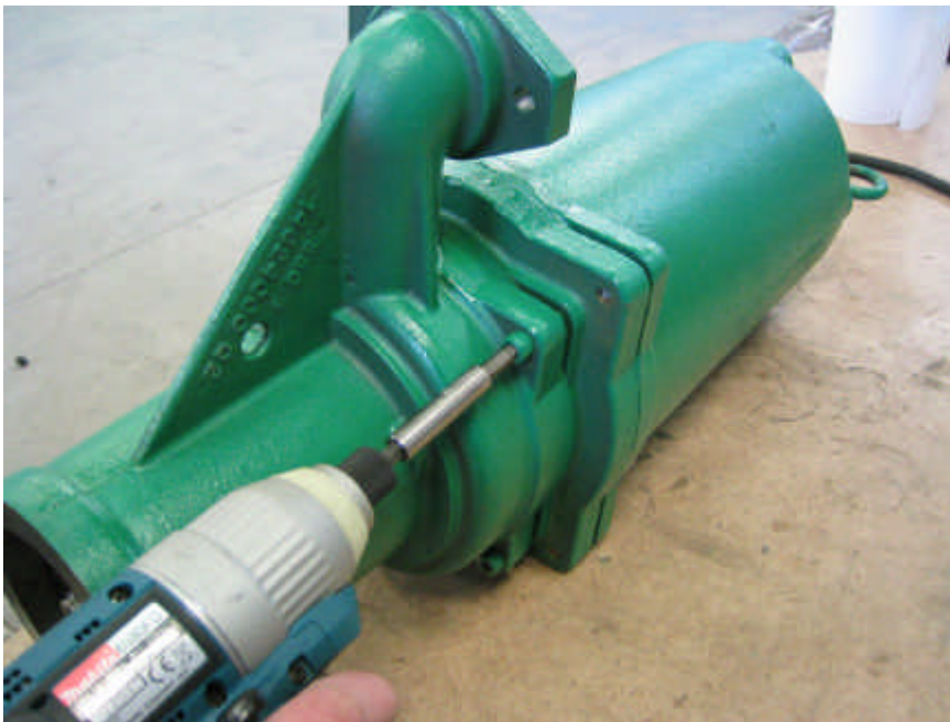
Kuva 6. Pumppupesän irrotus moottorista
