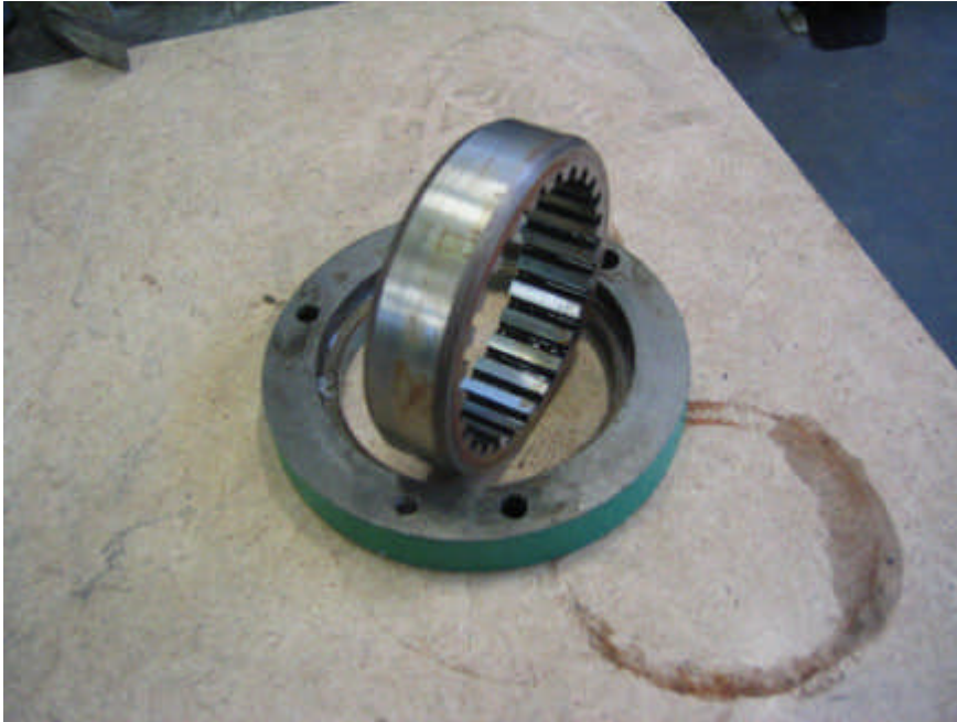
Kuva 3. Repijärengas on käännettävissä, jolloin uudet särmäreunat tulevat käyttöön.
