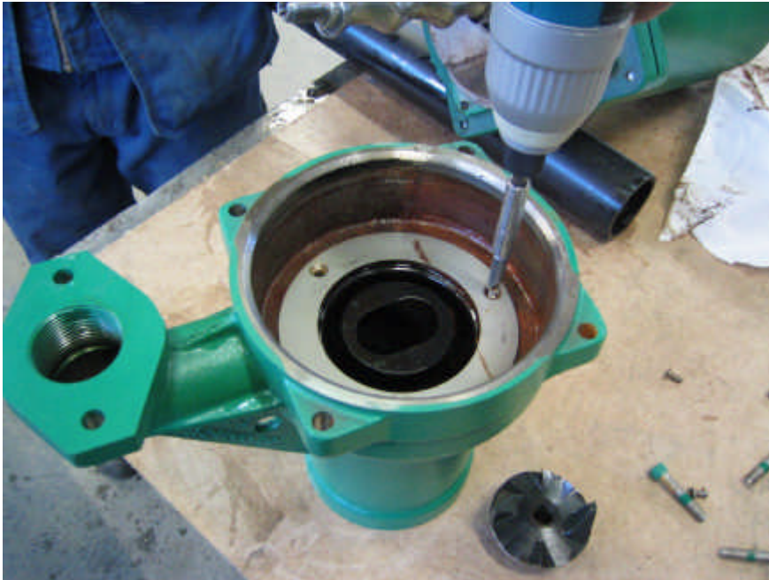
Kuva 7. Kumistaattorin pidäinrenkaan irrotus pesästä.
