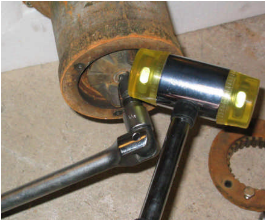
Kuva 4. Pyörivän terän irrotus akselista lyömällä. Akseli estetään pyörimästä pitämällä vastaan akselin päässä olevasta hahlostosta.
