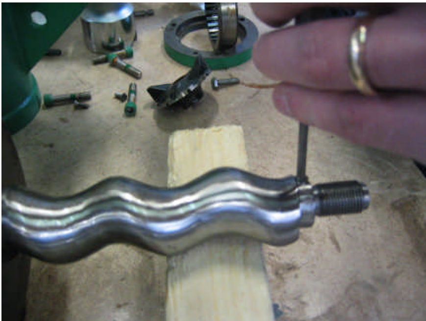
Kuva 8. Pumppuroottorin jousisokan irrotus.
